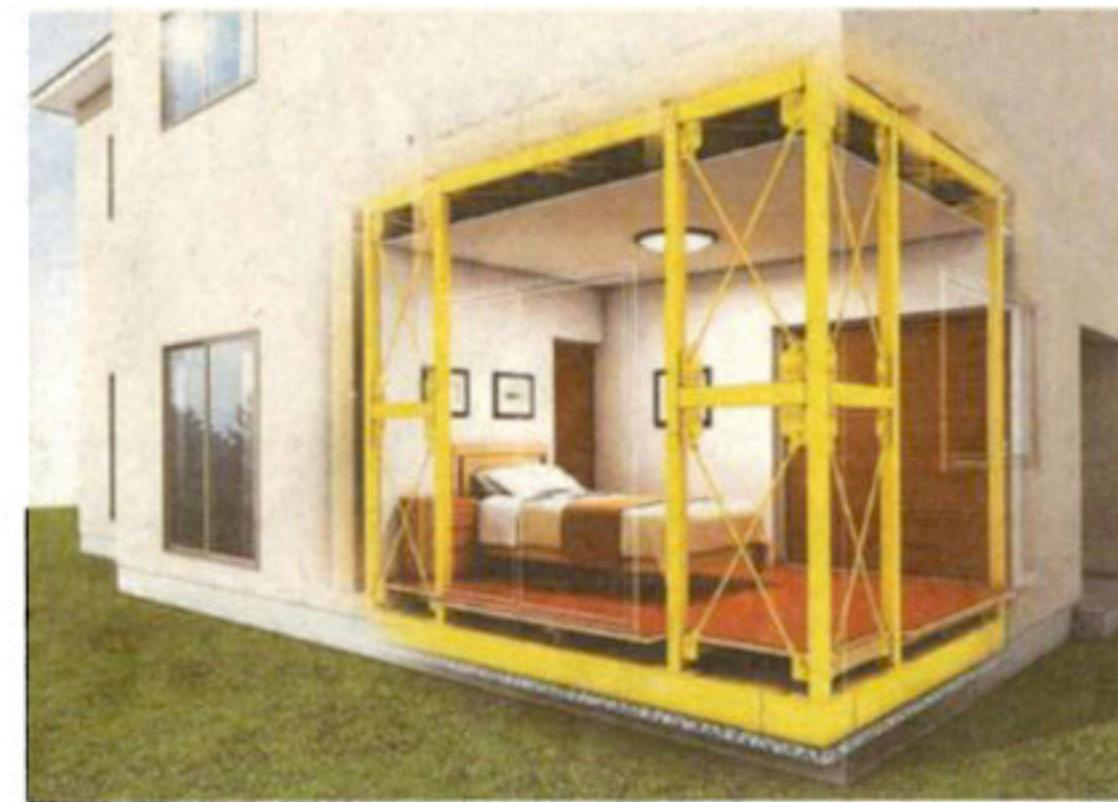
ンクリート構造と重量鉄骨構造を組み合わせたハイブリッド工法による建築住宅をつくる。木造在来工法の古い住宅の中に、建築基準法改正前（1981年）の旧耐震基準で建てられ、耐震性の低いものも多い。こうした低耐震性の住宅向けに、横浜国立大学大学院や建材メーカーなどと共同開発を進めてきた。
